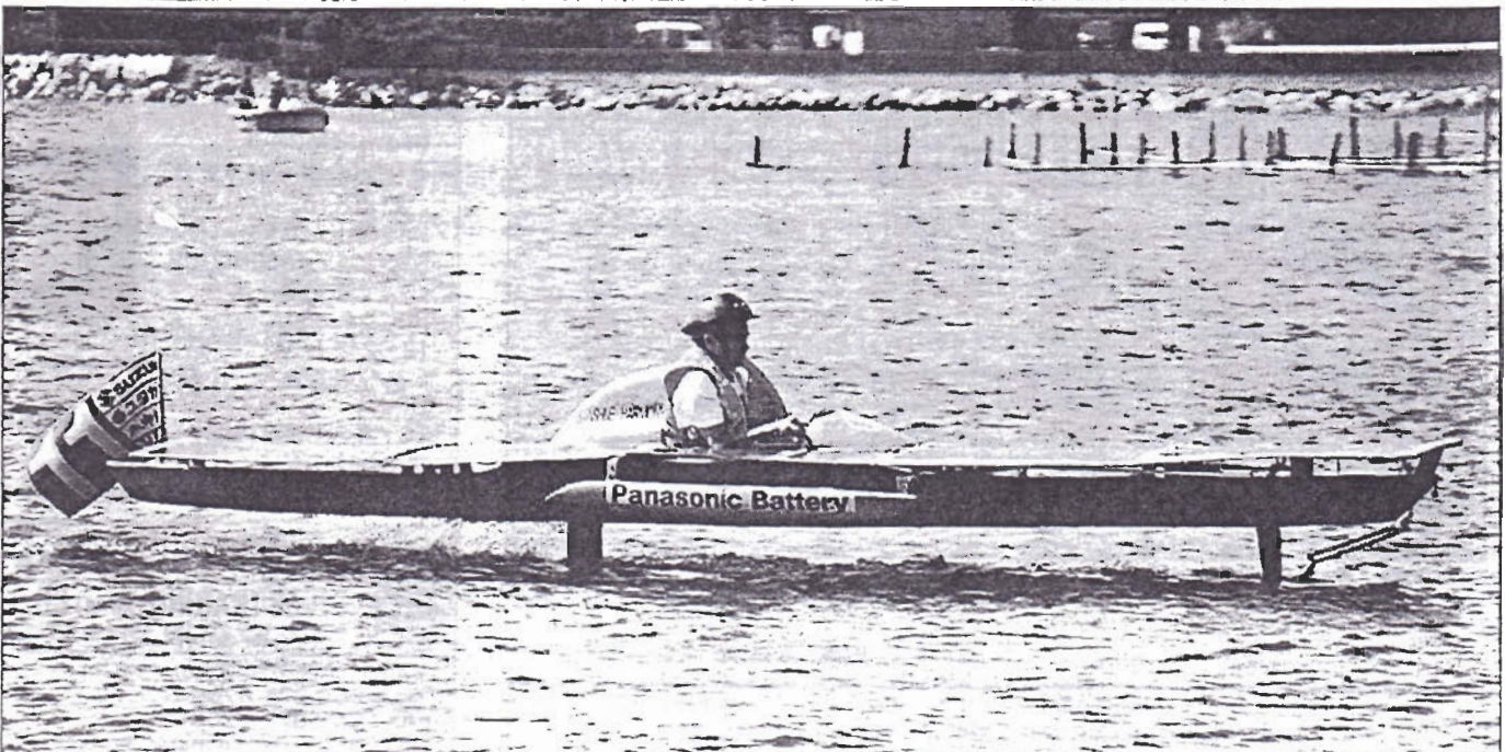
翼走する〈二代目虚空蔵〉。ステムに見えるのがハイトセンサーで、平行四辺形リンク式のアームの動きはワイヤーで前翼に伝えられ迎角を制御する
