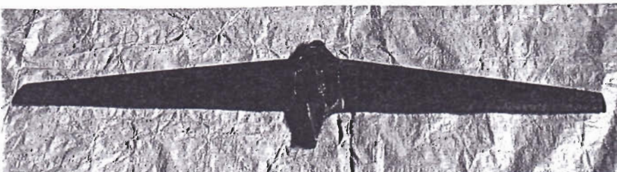
⑯ 主翼 (高速用) 翼面積小さく 離水に馬力が必要
