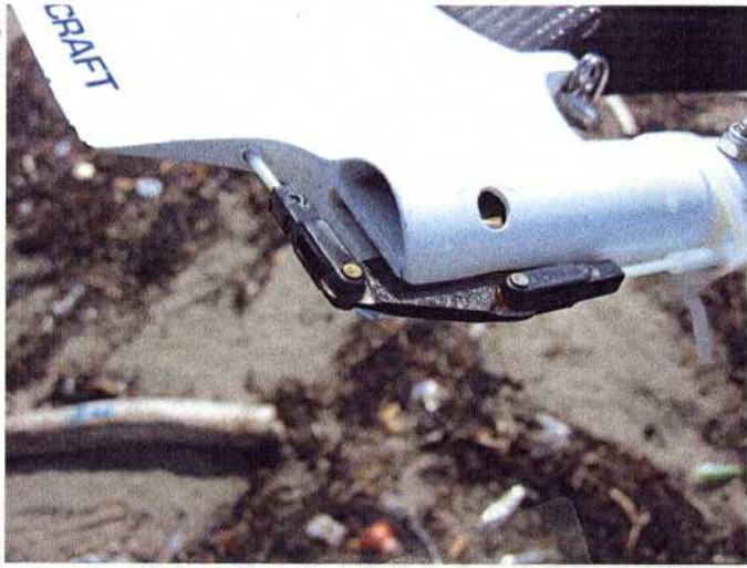
8 : 7の舵の頭を拡大したもの、このリンクでタブを動かす。
