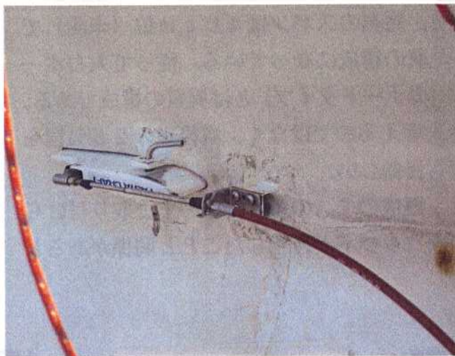
6 : デッキ側、L型ピンで主翼ストラットの抜止めをしている。又赤いボーデン索がセンサーとつながっていて、主翼のタブを操作する。センサーの詳細は会報36号で見えて頂ける。
