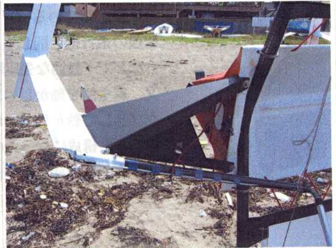
7 : 尾翼全景、尾翼位置を後退させるため黒い三角のブラケットを用いている。ティラーエクステンションを捻ると、タブが動くようになっている。ロックツーロックで10回転ぐらいだろうか。インジケーター付き。
