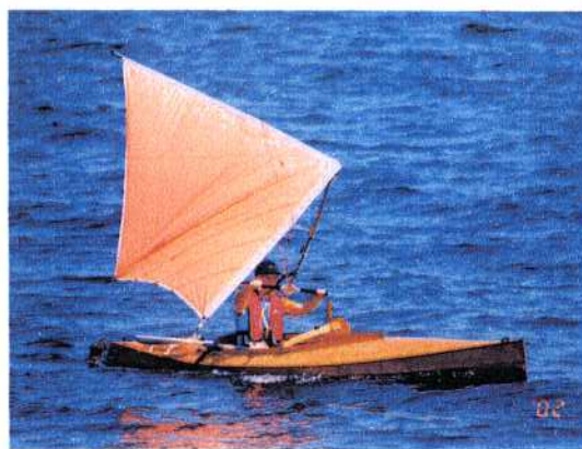
図-7 凧のように船を傾ける力が働かず、 畳むとパラソルのように一本の棒になる カイトセール
