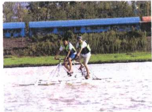
韓国の大学生が作った人力ボート。 力いっぱいペダルをこぐと、船体が浮いてスピードが急激に速くなっていました！
