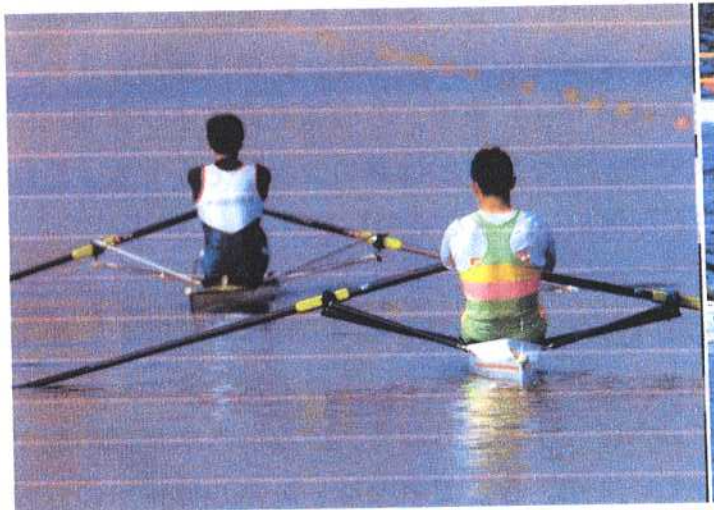
図1 喫水線の幅が僅か25cmのレース用スカル
