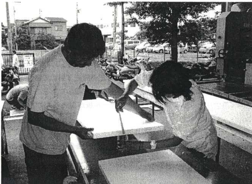
Photo.5 発泡スチロール厚板を長さ方向に接着しているところ
