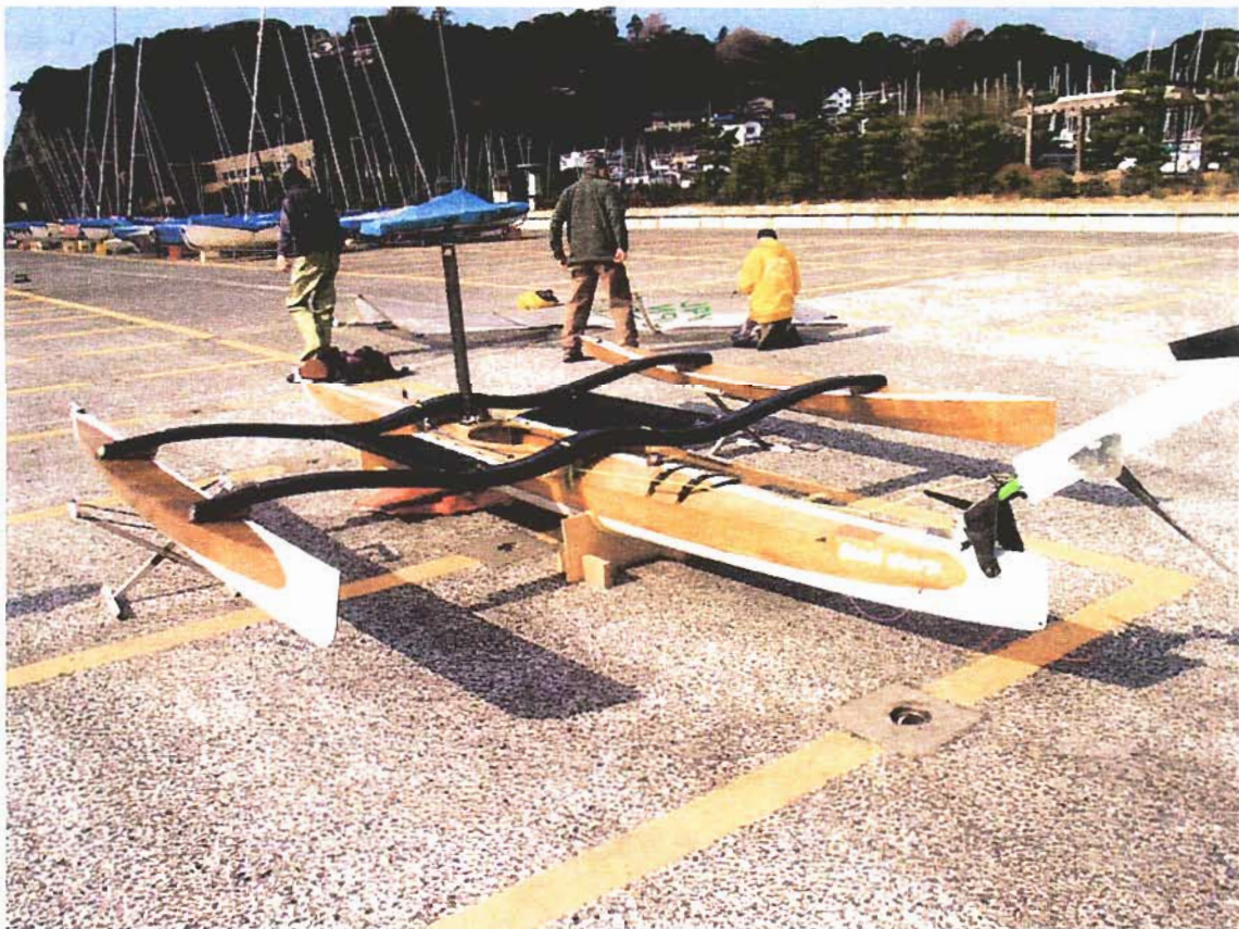
陸上の KF-50 （前脚は振り上げ、主翼は高く引き上げている）
