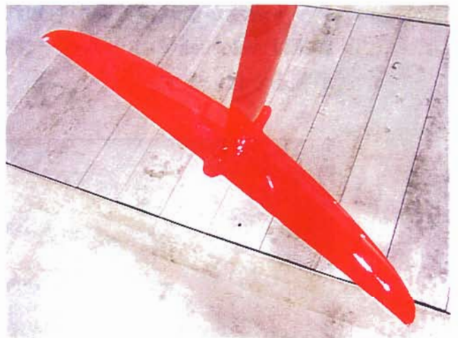
尾翼、タブ無し、舵軸で仰角を変える（下図）
