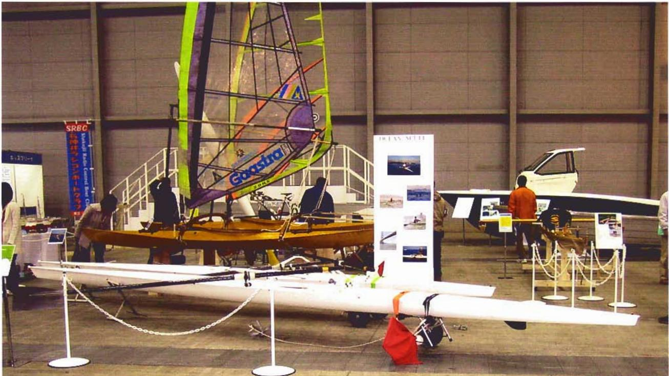
向こうのウインドサーフィンのセールが2枚付いた船は金井さんの新艇、合板のシーカヤック2杯を横に連結したカタマランヨットでそれぞれの船体に付けた2枚のセールで帆走します。まだ1回しか走っていませんが具合よく走るようです。
