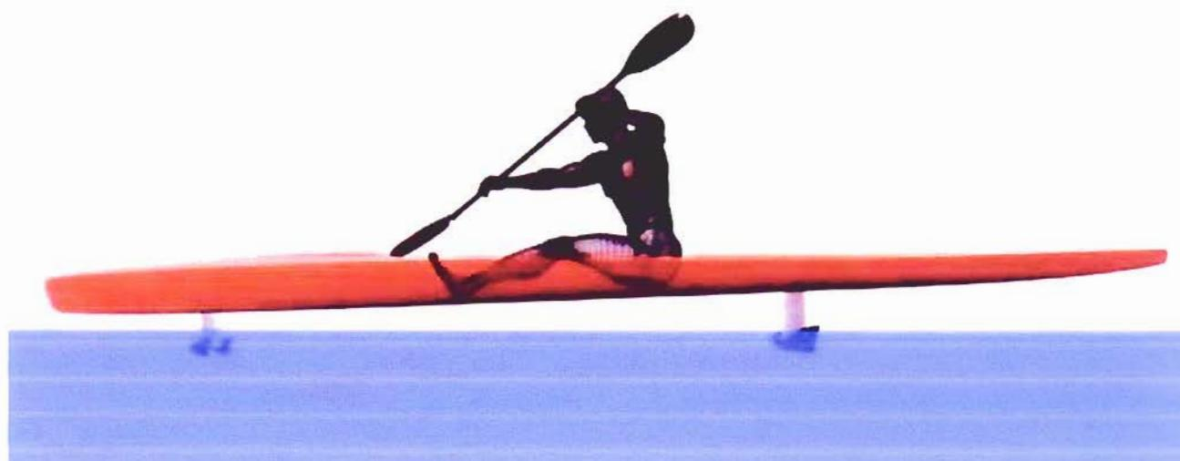
トップスピードでは離水速度より50%以上速くなります。そのときには前後の水中翼が翼の幅より少ない位の深さまで浮き上がり、その時のフライヤックは3度ほど前のめりになります。
