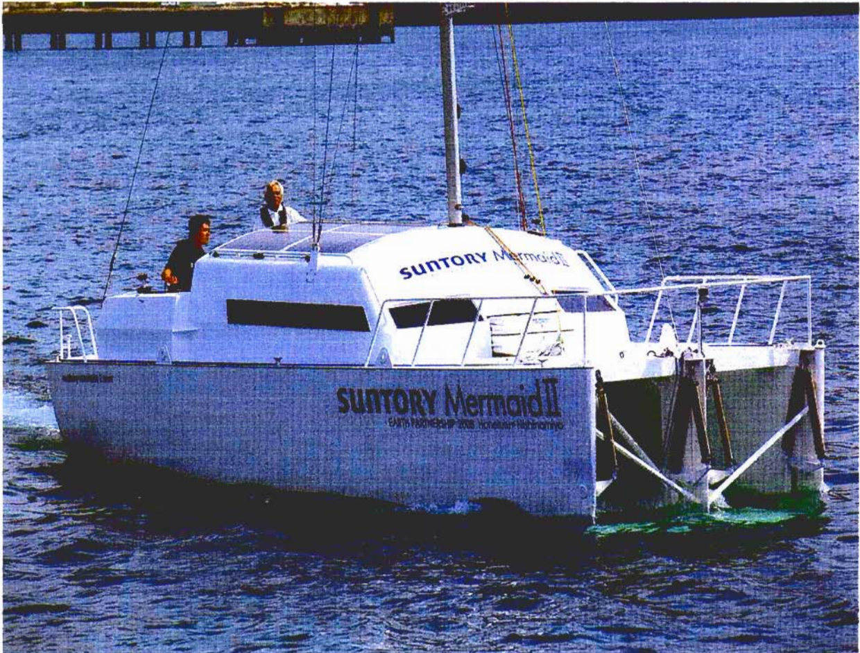
船外機で走る〈サントリー・マーメイドII〉。前端のフラップのおかげで全長9.5mのカタマランとしては非常に高い安定性を誇っている。ドッグハウスの上部はシャープ製の太陽電池で覆われており、前部にはライフラフトが収まっている
