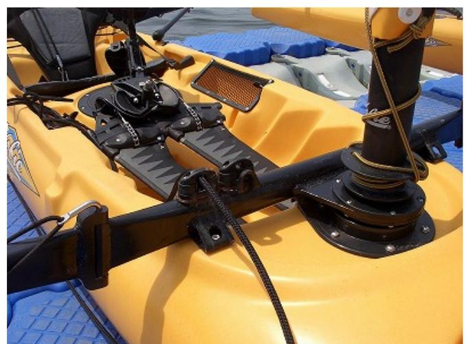
マストは自立式の回転マストでロープの巻き取りによって回転してセイルのローラーリーフが可能です。
