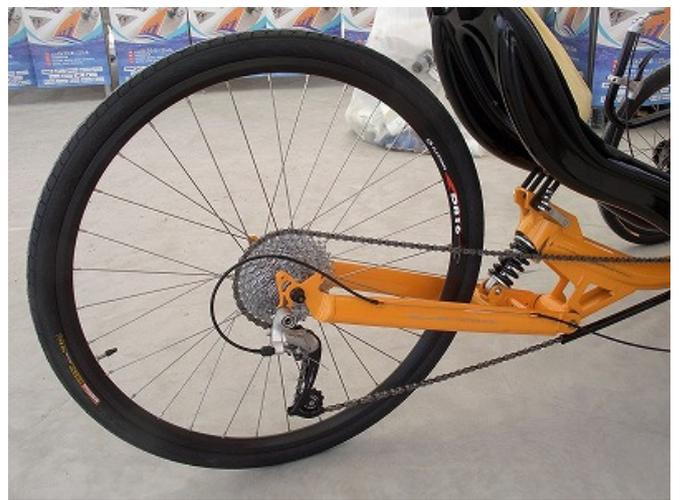
駆動はペダルからチェーンで後輪（ギヤは 9 段）を回し、操舵は前の 2 輪をシート横のスティックを両手で操作します。後輪はサスペンション付き。チェーンにはチューブ状のカバーが付いて、脚の怪我を防ぐ等、細部にもこだわっています。
