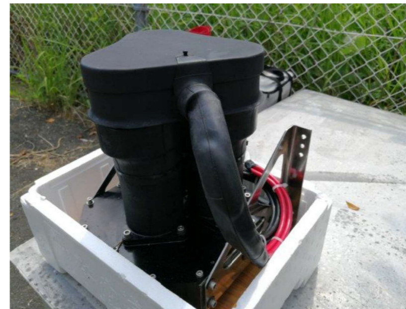
自慢の 3 連装モータユニットです。進水時は半分が水面に潜るためヘッド部を防水設計にしています。水冷と空冷の良いところ？ 自由なチャレンジ精神から生まれた逸品です。
