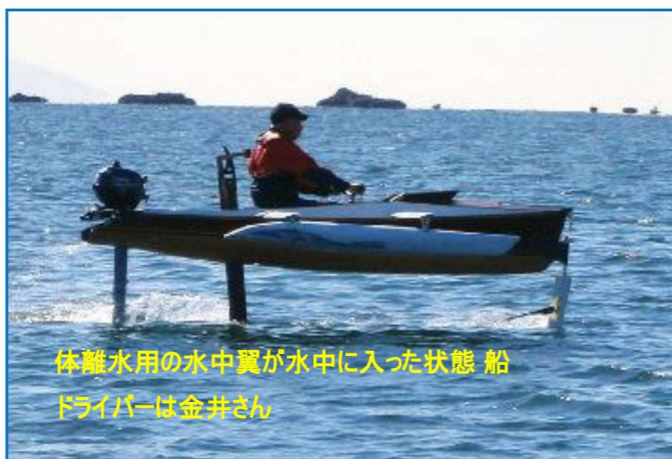
目標 20kt 寸前の 19.7kt この後、藻の塊の中に突っ込み、一部が損傷したため撤収(画像が斜め 後からで遠いのは、60psの4人乗りのボートがなかなか追いつけなかった ため)・・・再トライの予定
