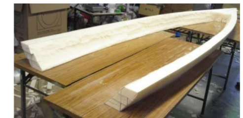
エサフォームの接着にエポキシを使ったのでサンディングした時に接着部が硬くて段が生じて大変だった。
