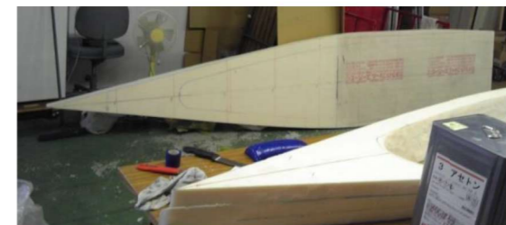
ストリンガーが入っていないのでセンターが分かり難くて大変だった(何度もセンターラインを書き込んで対応した)
